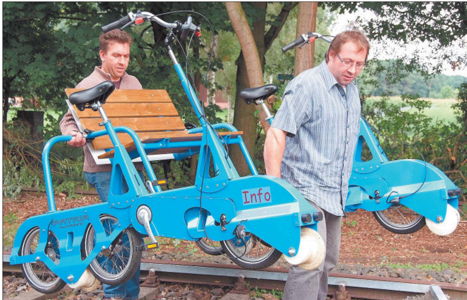
Noch wird am Endpunkt der Draisinenstrecke in Wagenfeld-Ströhen am Bahnsteig und an der Einsetzvorrichtung gebaut. Ulrich und Dietmar Koors zeigen, dass sich die Fahrzeuge aus Aluminium mit zwei Leuten leicht bewegen und auf die Schienen setzen lassen.
